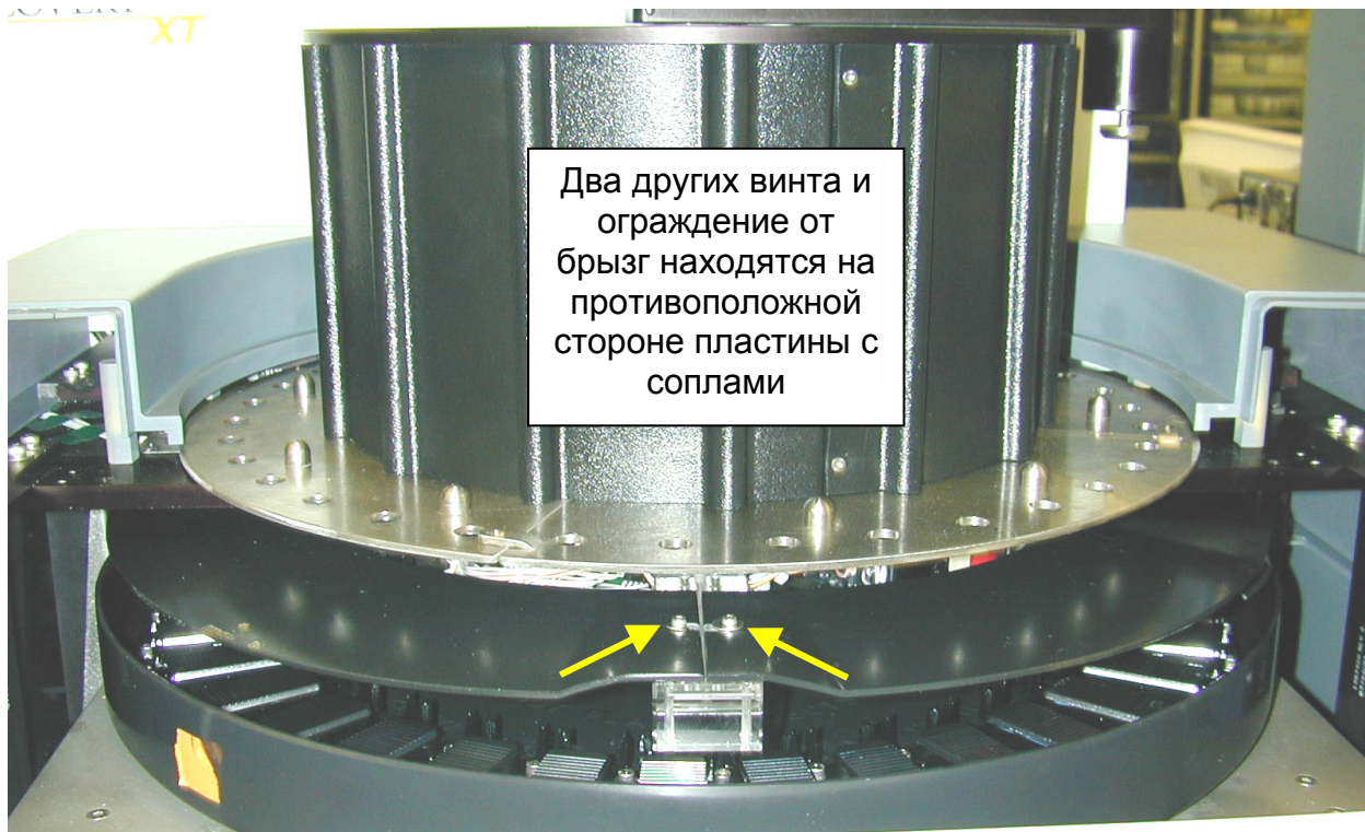
Рисунок 206. Щитки против протекания и винты
