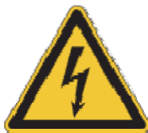
Рисунок 9. Ярлык «Осторожно! Опасность поражения электрическим током»
