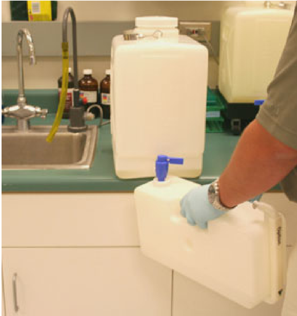
Рисунок 229. Пополнение баллонов для основных жидкостей свежими основными жидкостями
