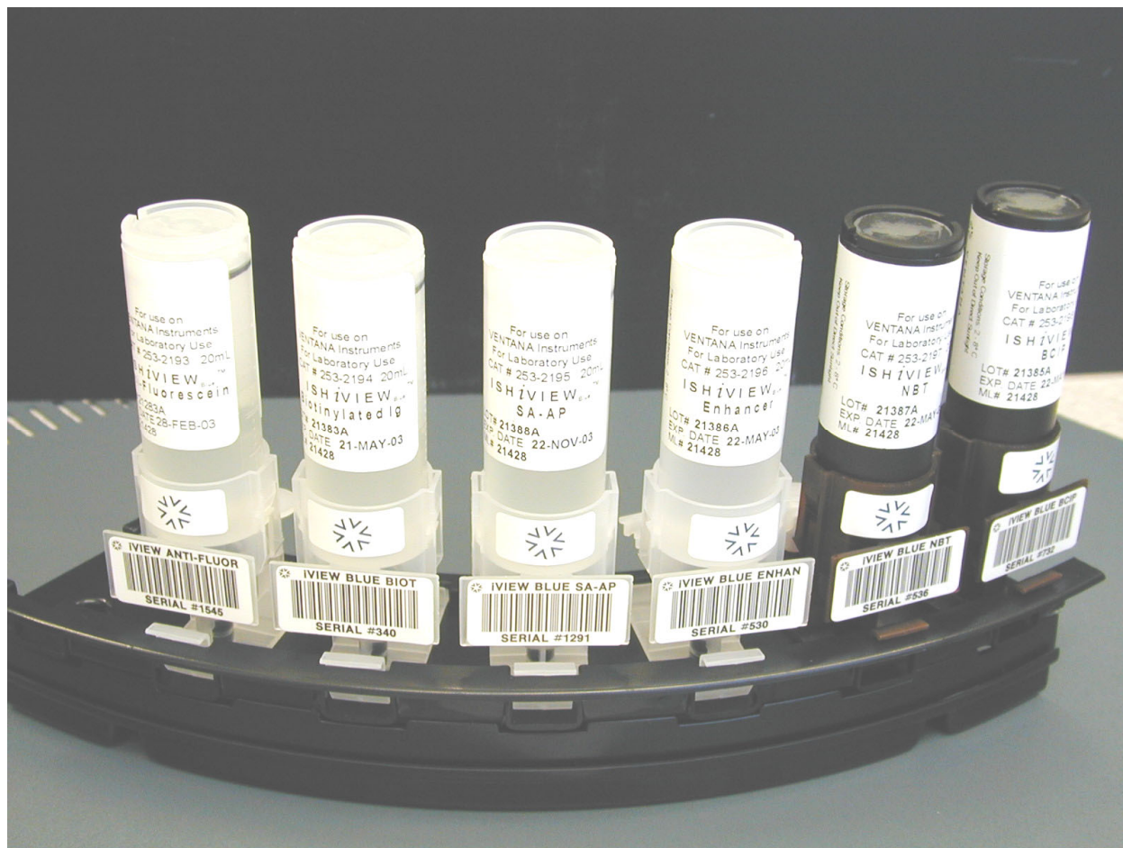
Рисунок 32. Лоток для реагентов с дозаторами
