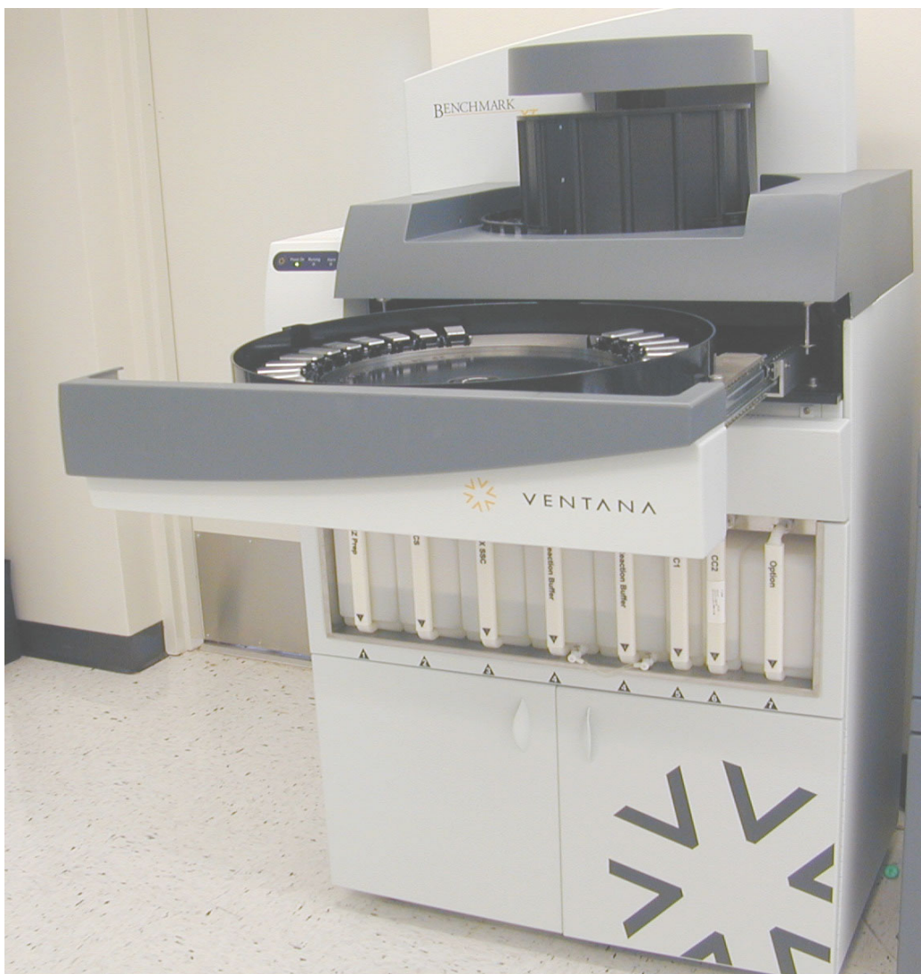
Рисунок 28. Выдвинутый лоток для предметных стекол (BenchMark XT)
