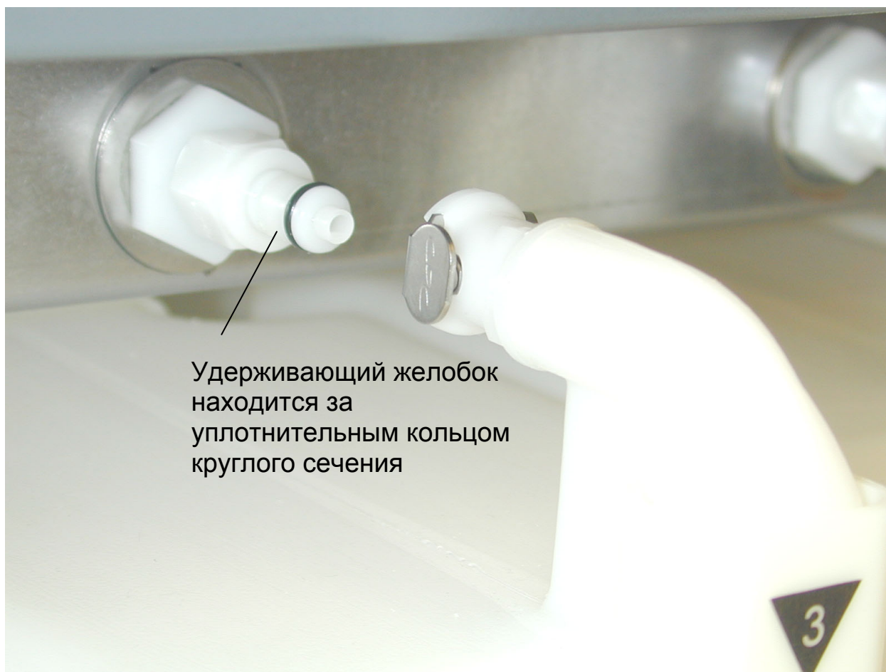
Рисунок 62. Введение в зацепление спаренного соединения
