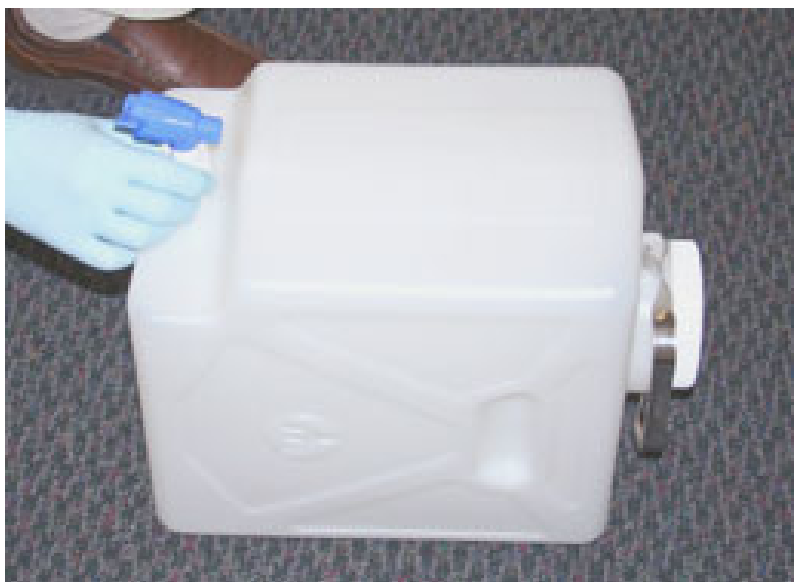
Рисунок 66. Кран, установленный на резьбовой разъем
