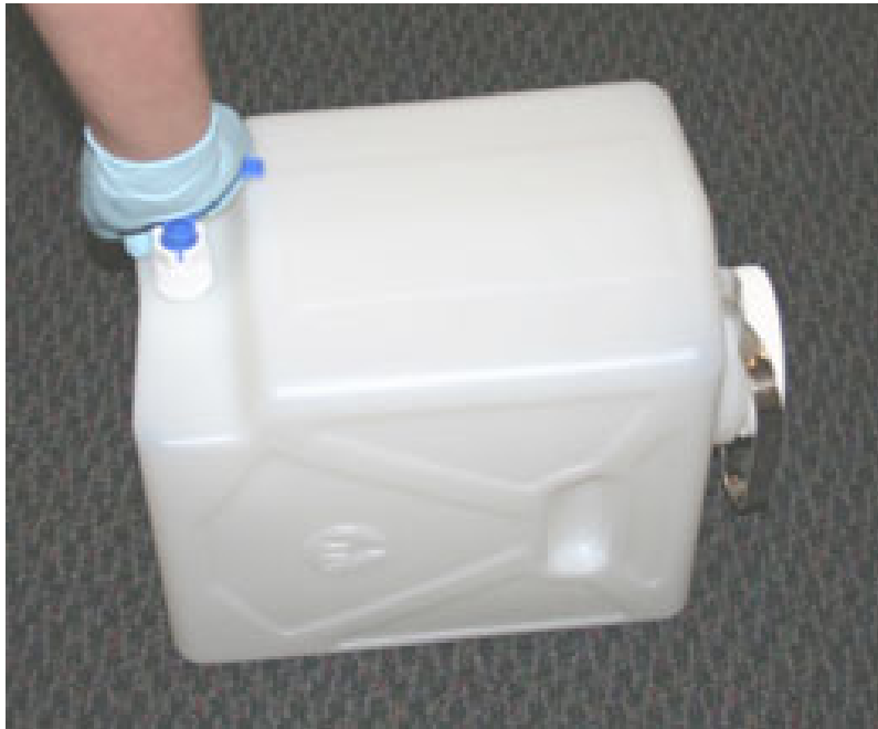
Рисунок 67. Закручивание стопорной гайки на кране
