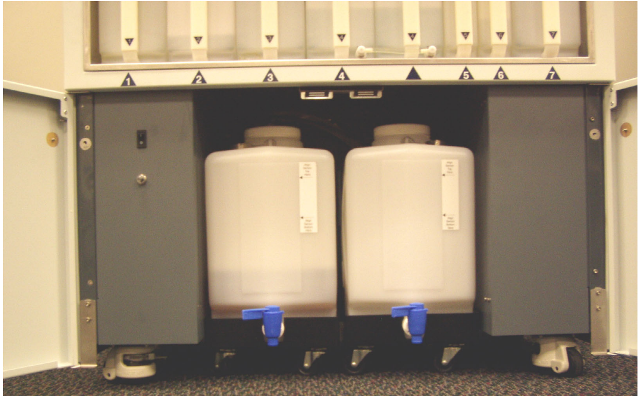
Рисунок 22. Подузел баллонов для отходов
