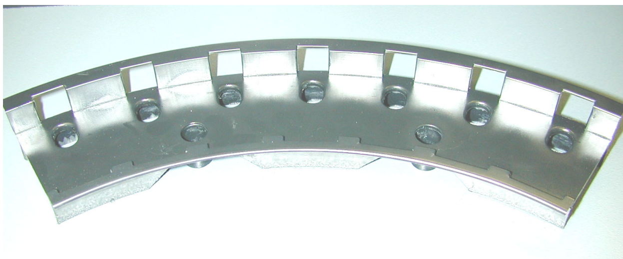
Рисунок 31. Лоток для реагентов без дозаторов
