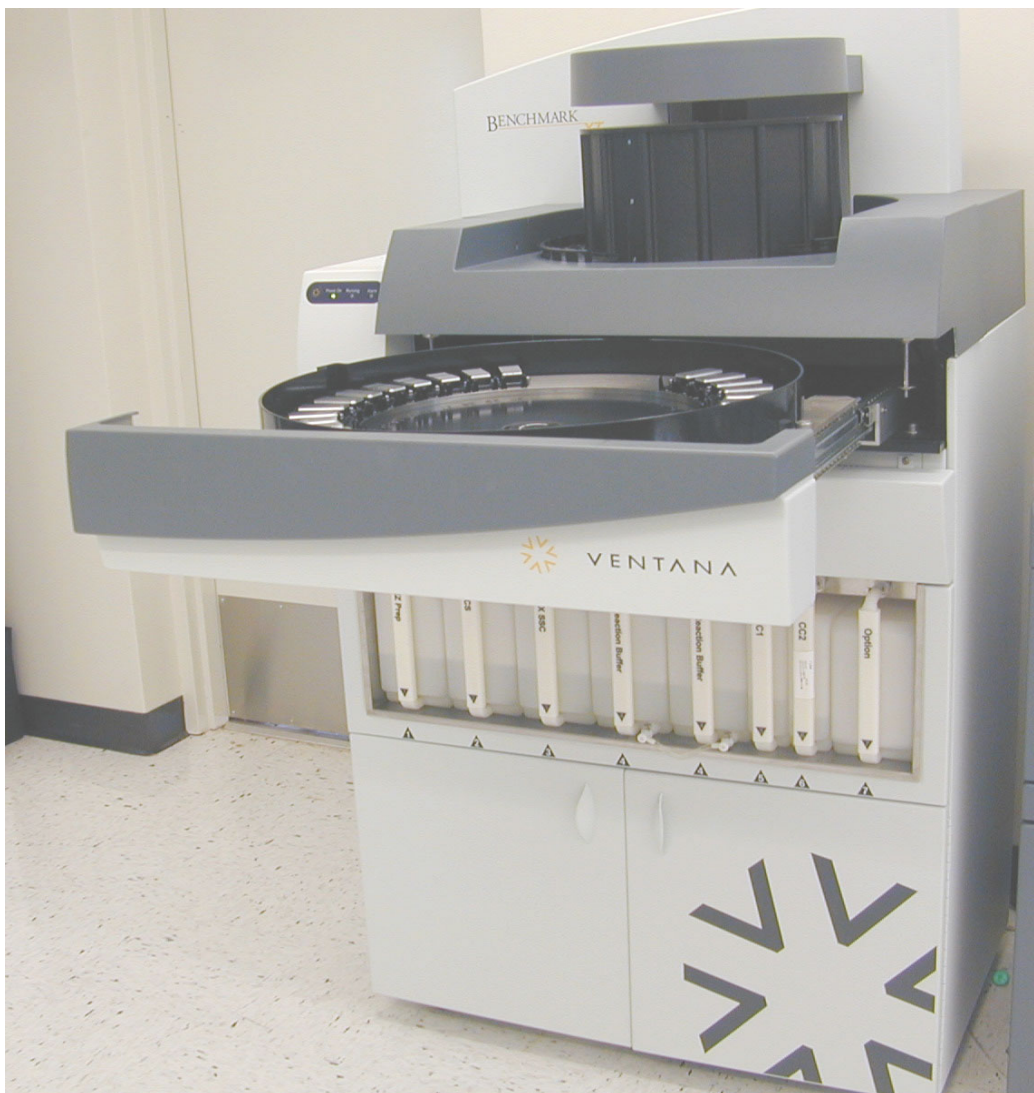
Рисунок 181. Выдвинутый лоток для предметных стекол (BenchMark XT)
